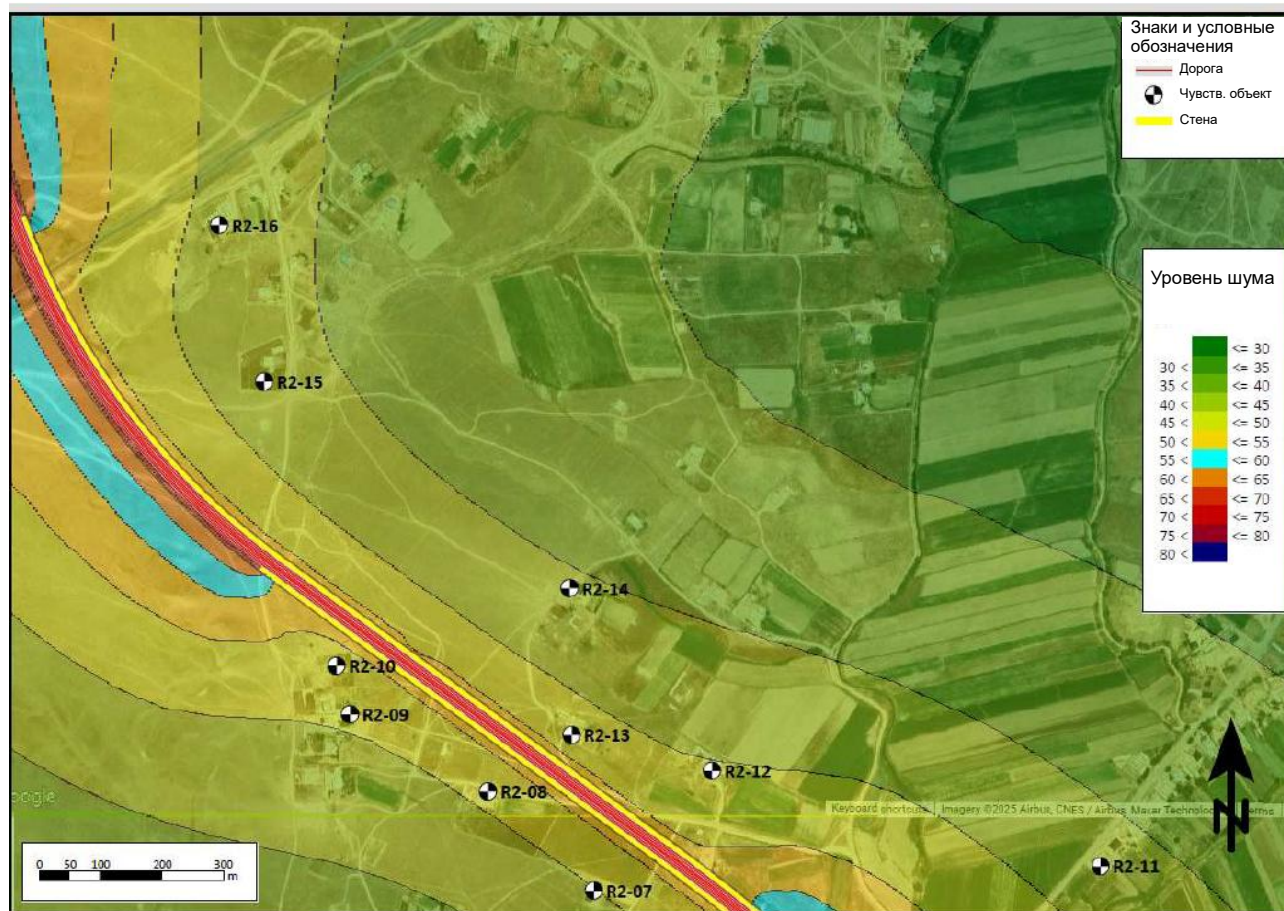
Рисунок 7-18. Участок 2 (северная часть): шумозащитные экраны и контуры зоны распространения шума с установкой шумозащитных экранов (дневное время, 2050 год)
