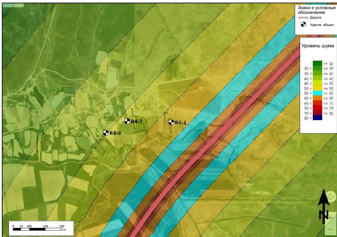
Рисунок 7-14. Участок 4: чувствительные объекты и контур зоны распространения шума в дневное время (2050 год)
