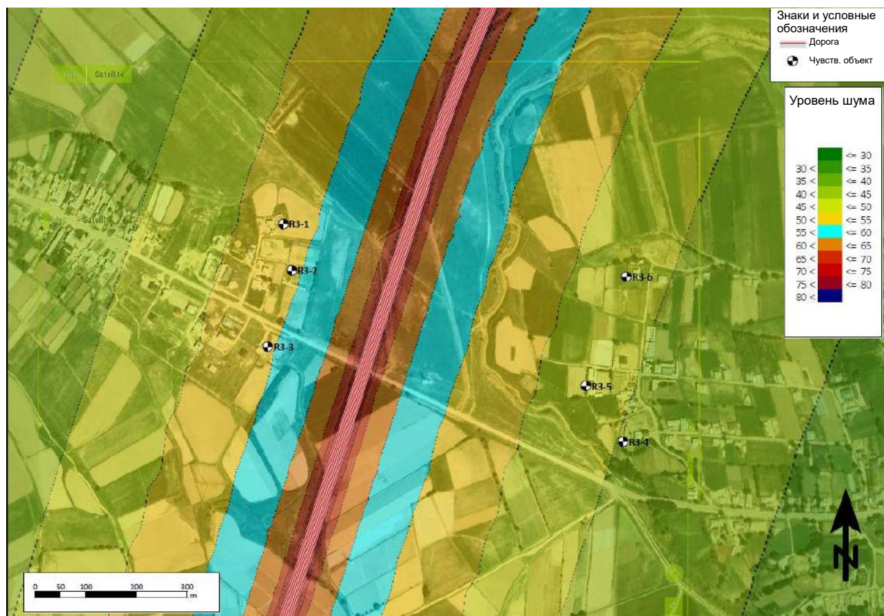
Рисунок 7-13. Участок 3: чувствительные объекты и контур зоны распространения шума в дневное время (2050 год)
